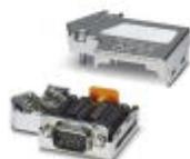
D-SUB-Stecker, 9-polig, Stift, Kabelzuführung unter 35°, Bussystem: PROFIBUS DP bis 12 MBit/s, Abschlusswiderstand über Schiebeschalter zuschaltbar, Pinbelegung: 3, 5, 6, 8; Schraubanschlussklemmen
