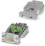
D-SUB-Stecker, 9-polig, Stift, axiale Ausführung mit zwei Kabelzuführungen, Bussystem: PROFIBUS DP bis 12 MBit/s, Abschlusswiderstand über Schiebeschalter zuschaltbar, Pinbelegung: 3, 5, 6, 8; Schraubanschlussklemmen
