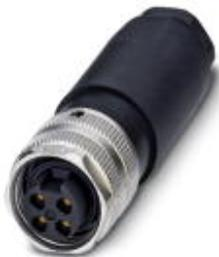
Steckverbinder, 4-polig, Buchse gerade 7/8"-16UNF, Schraubanschluss, Rändelmaterial: Zinkdruckguss, vernickelt, Kabelverschraubung Pg13,5, Kabelaußendurchmesser 10 mm ... 12 mm
