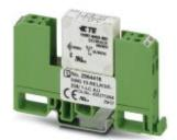
Relaismodul, mit fest eingelötetem Kleinschaltrelais, Goldkontakt für kleine Leistungen, 1 Schließer, Eingangsspannung 230 V AC/DC
