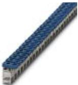
Anschlussklemme, Anschlussart: Schraubanschluss, Belastungsstrom: 125 A, Querschnitt: 2,5 mm<sup>2</sup> - 35 mm<sup>2</sup>, Breite: 14,3 mm, Farbe: blau
