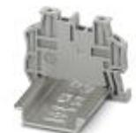
Schnellmontage-Endhalter, für Tragschiene NS 35/7,5 oder Tragschiene NS 35/15, mit Markierungsmöglichkeit, mit Parkmöglichkeit für FBS...5, FBS...6, KSS 5, KSS 6, Breite: 5,15 mm, Farbe: grau
