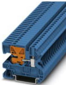
N-Trennklemme, zur Neutralleiter-Trennung, Schraubanschluss, Querschnitt: 0,14 mm<sup>2</sup> - 6 mm<sup>2</sup>, AWG: 26 - 10, Breite: 6,2 mm, Farbe: blau, Montageart: NS 35/7,5, NS 35/15
