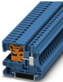
N-Trennklemme, zur Neutralleiter-Trennung, Schraubanschluss, Querschnitt: 0,2 mm<sup>2</sup> - 10 mm<sup>2</sup>, AWG: 24 - 8, Breite: 8,2 mm, Farbe: blau, Montageart: NS 35/7,5, NS 35/15
