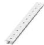
Zackband, Streifen, weiß, beschriftet, beschriftbar mit: CMS-P1-PLOTTER, quer bedruckt: fortlaufende Zahlen 1-10, 11-20 usw. bis 991-1000, Montageart: verrasten in hoher Schildchennut, für Klemmenbreite: 10,2 mm, Schriftfeldgröße: 10,15 x 10,5 mm
