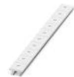
Zackband, Streifen, weiß, beschriftet, beschriftbar mit: CMS-P1-PLOTTER, längs bedruckt: gleiche Zahlen 1 oder 2 usw. bis 100, Montageart: verrasten in hoher Schildchennut, für Klemmenbreite: 10,2 mm, Schriftfeldgröße: 10,15 x 10,5 mm
