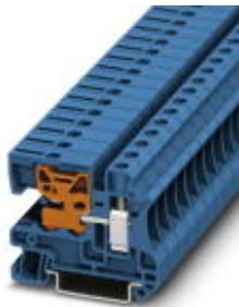
N-Trennklemme, zur Neutralleiter-Trennung, Schraubanschluss, Querschnitt: 0,5 mm<sup>2</sup> - 16 mm<sup>2</sup>, AWG: 20 - 6, Breite: 10,2 mm, Farbe: blau, Montageart: NS 35/7,5, NS 35/15
