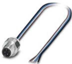
Sensor-/Aktor-Einbaustecker, 4-polig, M12, A-kodiert, Vorderwand-/Schraubmontage mit Pg9 Gewinde, positionierbar, mit 0,5 m TPE-Litze, 4 x 0,34 mm<sup>2</sup>, Edelstahlausführung
