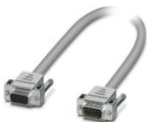
Konfektioniertes, geschirmtes Rundkabel; Anschluss 1: D-SUB-Buchsenleiste (1x 9-polig); Anschluss 2: D-SUB-Stiftleiste (1x 9-polig); Kabellänge: 0,5 m
