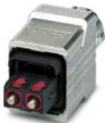
LWL-Steckverbinder SC-RJ, IP67, mit Push-Pull Verriegelung, Metallgehäuse, duplex, mit Schnellanschlusstechnik, für PCF-Faser 200/230 µm, für Einzeladerdurchmesser 2,2 mm, für Kabeldurchmesser 6,5 mm ... 9,5 mm
