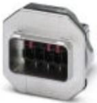
MSTB-Anbaurahmen, IP67, für Push-Pull Verriegelung, Metall, mit integriertem Kontakteinsatz für Leiteranschluss, Federkraftanschluss, 24 V, für runden Montageausschnitt, mit Dichtung, ohne Befestigungsschrauben
