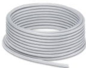
PROFINET-Powerkabel, 5x 2,5 mm<sup>2</sup>, flexibel (7-drätig), Außenmantel: PVC, Außendurchmesser 11,8 mm, RAL 7001 (silbergrau), ölbeständig, Kabelring: 100 m
