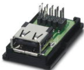
USB-Buchseneinsatz, 4-polig, Buchse USB Typ A auf Flachbandkabel-Anschlussleiste, Rastermaß 2,54, für das Freenet-System im Anbaurahmen, Terminaloutlet IP20, 19" Patch-Panel und Service-Interface
