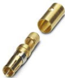
Koax-Kontakt, für D-SUB-Kombinationseinsätze, Lötkelch, Buchse, gerade, für Kabel RG 58, vergoldet
