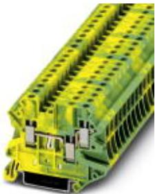
Schutzleiter-Reihenklemme, Anschlussart: Schraubanschluss, Anzahl der Anschlüsse: 3, Querschnitt: 0,14 mm<sup>2</sup> - 6 mm<sup>2</sup>, AWG: 26 - 10, Breite: 6,2 mm, Höhe: 46,9 mm, Farbe: grün-gelb, Montageart: NS 35/7,5, NS 35/15
