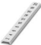
Zackband flach, Streifen, weiß, beschriftet, längs bedruckt: fortlaufende Zahlen 2-20, 22-40, usw. bis 82-100, Montageart: verrasten in flacher Schildchennut, für Klemmenbreite: 5 mm, Schriftfeldgröße: 5,15 x 5,15 mm
