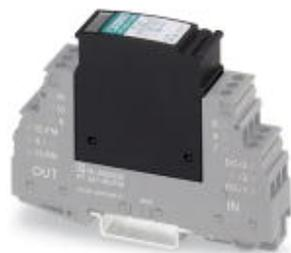
Überspannungsschutzstecker mit integrierter Statusanzeige am Modul und Fernmeldekontakt für zwei Signaladern mit gemeinsamem Bezugspotenzial. Nennspannung: 24 V AC
