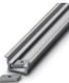
Tragschiene ungelocht, Standardprofil, Breite: 35 mm, Höhe: 15 mm, ähnlich EN 60715: 2001, Material: Aluminium, unbeschichtet, Länge: 2000 mm, Farbe: silberfarben
