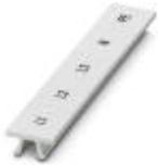
Marker für Klemmen, Streifen, weiß, beschriftet, längs bedruckt: L1, L2, L3, N, PE, Montageart: verrasten in hoher Schildchennut, für Klemmenbreite: 12,2 mm, Schriftfeldgröße: 10,5 x 12,15 mm
