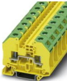
Schutzleiterklemme mit Bolzenanschlusstechnik, Querschnitt: 0,1 - 6 mm<sup>2</sup>, AWG: 26 - 10, Breite 16,3 mm, Farbe: grün-gelb
