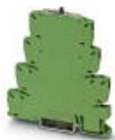
PLC-INTERFACE mit Schalter (Bedienung: händisch) für die Funktionen "Manuell, Null und Automatik", mit Zugfederanschluss und integriertem Leistungskontaktrelais , zur Montage auf Tragschiene NS 35/7,5, 1 Schließer, Eingangsspannung 24 V AC/DC
