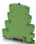
PLC-INTERFACE mit Schalter (Bedienung: Schraubendreher) für die Funktionen "Manuell, Null und Automatik", mit Zugfederanschluss und integriertem Leistungskontaktrelais, zur Montage auf Tragschiene NS 35/7,5, 1 Schließer, Eingangsspannung 24 V AC/DC
