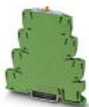
PLC-INTERFACE mit Schalter (Bedienung: händisch) für die Funktionen "Manuell, Null und Automatik", mit Schraubanschluss und integriertem Leistungskontaktrelais , zur Montage auf Tragschiene NS 35/7,5, 1 Schließer, Eingangsspannung 24 V AC/DC
