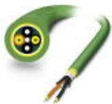
PROFINET-HCS-GI-Faserkabel, duplex 200/230  $\mu$ m, erhöhte Bandbreite speziell für Ethernet-Applikationen. Robuster PUR-Außenmantel. Schwere Ausführung, Schleppketten geeignet, für Verlegung im Innenbereich, Meterware ohne Stecker
