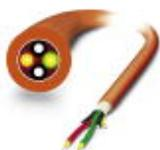
Konfektionierbare, robuste PCF-Installationsleitung (nur IP20-Köpfe) für Verlegung in stationären Anlagen und Maschinen, Aramid-Zugentlastungselemente, Einzelelemente aus FRNC-Material, halogenfrei, Ozon- und UV-beständig, mit Polyurethan-(PUR)-Außenmantel
