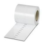
Marker für Klemmen, Rolle, weiß, unbeschriftet, beschriftbar mit: THERMOMARK ROLL, THERMOMARK ROLL X1, THERMOMARK ROLLMASTER 300/600, THERMOMARK X1.2, THERMOMARK S1.1, perforiert, Montageart: verrasten in Universalschildchennut, verrasten in flacher Schildchennut, für Klemmenbreite: 5,2 mm, Schriftfeldgröße: 6,4 x 5,15 mm
