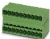
Grundgehäuse, Nennstrom: 10 A, Bemessungsspannung (III/2): 320 V, Polzahl: 3, Rastermaß: 5 mm, Farbe: grün, Kontaktoberfläche: Zinn, Montage: Wellenlöten, Bei Kombination mit MVSTB- oder FKCV-Steckerteilen ist jeweils ein MVSTBW- (bzw. FKCVW-) und ein MVSTBR-Stecker (bzw. FKCVR-) zu verwenden. Kombination mit TMSTBP-Steckerteilen ist nicht möglich!
