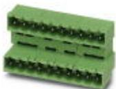
Grundgehäuse, Nennstrom: 10 A, Bemessungsspannung (III/2): 320 V, Polzahl: 3, Rastermaß: 5 mm, Farbe: grün, Kontaktfläche: Zinn, Montage: Wellenlöten, Der Artikel ist zu unterschiedlichen Polzahlen anreihbar! Bei Kombination mit MVSTB- oder FKCV-Steckerteilen ist jeweils ein MVSTBW- (bzw. FKCVW-) und ein MVSTBR-Stecker (bzw. FKCVR-) zu verwenden. Kombination mit TMSTBP-Steckerteilen ist nicht möglich!
