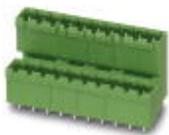
Grundgehäuse, Nennstrom: 10 A, Bemessungsspannung (III/2): 320 V, Polzahl: 3, Rastermaß: 5 mm, Farbe: grün, Kontaktfläche: Zinn, Montage: Wellenlöten, Der Artikel ist zu unterschiedlichen Polzahlen anreihbar! Bei Kombination mit MVSTB- oder FKCV-Steckerteilen ist jeweils ein MVSTBW- (bzw. FKCVW-) und ein MVSTBR-Stecker (bzw. FKCVR-) zu verwenden. Kombination mit TMSTBP-Steckerteilen ist nicht möglich!
