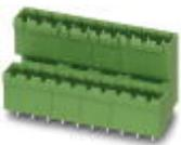
Grundgehäuse, Nennstrom: 10 A, Bemessungsspannung (III/2): 320 V, Polzahl: 3, Rastermaß: 5 mm, Farbe: grün, Kontaktoberfläche: Zinn, Montage: Lötten, Der Artikel ist zu unterschiedlichen Polzahlen anreihbar! Bei Kombination mit MVSTB- oder FKCV-Steckerteilen ist jeweils ein MVSTBW- (bzw. FKCVW-) und ein MVSTBR-Stecker (bzw. FKCVR-) zu verwenden. Kombination mit TMSTBP-Steckerteilen ist nicht möglich!
