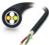
Konfektionierbare, hochrobuste PCF-Rundleitung (nur IP20-Köpfe) für die Außenverlegung mit integrierter Dampfsperre, sowie nagetierfester Glasgarnlage. Einzelelemente aus hochflexiblem FRNC-Material. Die Leitung ist Ozon- und UV-beständig mit sehr robustem Polyethylen-Außenmantel.
