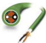
Konfektionierbare, hochflexible POF-PROFINETleitung (nur IP20-Köpfe), für den Einsatz in Schleppketten. Einzelelemente aus hochstrapazierfähigem Polyamid (PE). Die Leitung ist halogenfrei, Ozon- und UV-beständig, mit robustem Polyurethan (PUR) Außenmantel.
