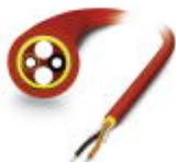
Konfektionierbare, robuste POF-Installationsleitung (nur IP20-Köpfe) für Verlegung in stationären Anlagen und Maschinen, Einzelelemente aus Polyamid (PE), halogenfrei, Ozon- und UV-beständig, mit verstärktem Polyurethan-(PUR)-Außenmantel
