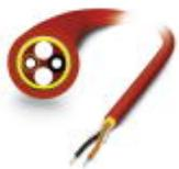
Polymerfaserkabel, duplex 980 µm / 1000 µm, schwere Ausführung für die Verlegung in stationären Anlagen und Maschinen, Meterware ohne Stecker
