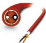
Konfektionierbare, hochflexible POF-Rundleitung (nur IP20-Köpfe) für den Einsatz in Schleppketten. Einzelelementen aus hochstrapazierfähigem Polyamid (PE). Die Leitung ist halogenfrei, Ozon- und UV-beständig mit robustem Polyurethan (PUR) Außenmantel.
