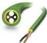
Konfektionierbare POF-PROFINET-Installationsleitung (nur IP20-Köpfe), für Verlegung in stationären Anlagen und Maschinen, Einzelelemente aus Polyamid (PE), halogenfrei, Ozon- und UV-beständig, mit verstärktem Polyurethan-(PUR)-Außenmantel
