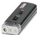
Mikroskop zur optischen Kontrolle nach der Steckerkonfektionierung. 100x Vergrößerung, mit Beleuchtung. Verwendbar für B-FOC (ST<sup>®</sup>) / SC / SC-Duplex Stecker. Abmessungen: (L x B x H) 148 x 44 x 23 mm
