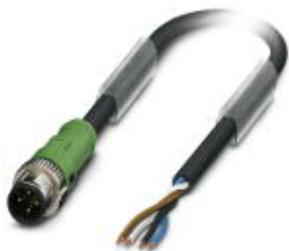
Sensor-/Aktor-Kabel, 4-polig, PUR, schwarzgrau RAL 7021, Stecker gerade M12 SPEEDCON, A-kodiert, auf freies Leitungsende, Kabellänge: 5 m
