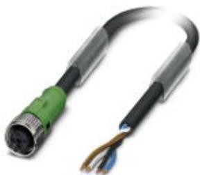
Sensor-/Aktor-Kabel, 4-polig, PUR, schwarzgrau RAL 7021, freies Leitungsende, auf Buchse gerade M12 SPEEDCON, A-kodiert, Kabellänge: 15 m
