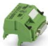
V8-Adapter für 8 x PLC-INTERFACE (6,2 mm); Steuerung: SPS-Systemverkabelung von Eingangskarten; Anschluss 1: Steckanschluss; Anschluss 2: 1x D-SUB-Buchsenleiste (15-polig); Anzahl der Kanäle: 8; Ansteuerlogik: plusschaltend
