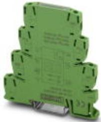
PLC-INTERFACE für NAMUR-Anwendungen, bestehend aus Grundklemme PLC-BSC.../21 mit Schraubanschluss und integrierter Schaltung, zur Montage auf Tragschiene NS 35/7,5, plusschaltend, 1 Schließer, Eingangsspannung 24 V DC
