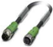
Sensor-/Aktor-Kabel, 4-polig, PUR, schwarzgrau RAL 7021, Stecker gerade M12 SPEEDCON, A-kodiert, auf Buchse gerade M12 SPEEDCON, A-kodiert, Kabellänge: 2 m
