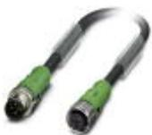
Sensor-/Aktor-Kabel, 4-polig, PUR, schwarzgrau RAL 7021, Stecker gerade M12 SPEEDCON, A-kodiert, auf Buchse gerade M12 SPEEDCON, A-kodiert, Kabellänge: 15 m
