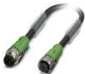
Sensor-/Aktor-Kabel, 4-polig, PUR, schwarzgrau RAL 7021, Stecker gerade M12 SPEEDCON, A-kodiert, auf Buchse gerade M12 SPEEDCON, A-kodiert, Kabellänge: 0,5 m
