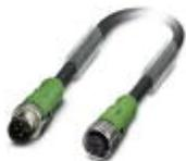
Sensor-/Aktor-Kabel, 4-polig, PUR, schwarzgrau RAL 7021, Stecker gerade M12 SPEEDCON, A-kodiert, auf Buchse gerade M12 SPEEDCON, A-kodiert, Kabellänge: 0,3 m
