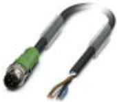
Sensor-/Aktor-Kabel, 4-polig, PUR, schwarzgrau RAL 7021, Stecker gerade M12 SPEEDCON, A-kodiert, auf freies Leitungsende, Kabellänge: 2 m
