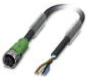
Sensor-/Aktor-Kabel, 4-polig, PUR, schwarzgrau RAL 7021, freies Leitungsende, auf Buchse gerade M12 SPEEDCON, A-kodiert, Kabellänge: 10 m
