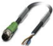
Sensor-/Aktor-Kabel, 4-polig, PUR, schwarzgrau RAL 7021, Stecker gerade M12 SPEEDCON, A-kodiert, auf freies Leitungsende, Kabellänge: 15 m
