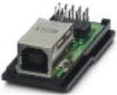
USB-Buchseinsatz, 4-polig, Buchse USB Typ B auf Flachbandkabel-Anschlussleiste, Rastermaß 2,54, für das Freenet-System im Anbaurahmen, Terminaloutlet IP20, 19" Patch-Panel und Service-Interface
