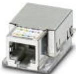
RJ45-Buchseneinsatz, Schutzart: IP20, Polzahl: 8, CAT5 (IEC 11801:2002), Material: Kupferlegierung, Anschlussart: IDC, Anschlussquerschnitt: AWG 24-22
