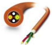
Konfektionierbare, robuste GOF-Installationsleitung (nur IP20-Köpfe) für Verlegung in stationären Anlagen und Maschinen, Aramid-Zugentlastungselemente, Einzelelemente aus FRNC-Material, halogenfrei, Ozon- und UV-beständig, mit Polyurethan-(PUR)-Außenmantel
