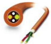
Konfektionierbare, robuste GOF-Installationsleitung für den Innenbereich mit hochreißfesten Aramid-Zugentlastungselementen. Einzelelemente bestehen aus hochflexiblem FRNC-Material. Die Leitung ist halogenfrei, Ozon- und UV-beständig mit einem robuste Polyurethan (PUR) Außenmantel.
