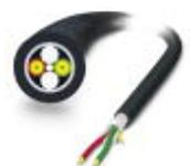
Konfektionierbare, hochrobuste GOF-Rundleitung (nur IP20-Köpfe) für die Außenverlegung mit integrierter Dampfsperre sowie nagetierfester Glasgarnlage. Einzelelemente aus hochflexiblem FRNC-Material. Die Leitung ist Ozon- und UV-beständig mit sehr robustem Polyethylen-Außenmantel.
