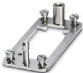
Andockrahmen für Einschübe, für Kontakteinsätze der Bauform B10, mit 4 Flachkopfschrauben M5, Einschubausgleich x/y-Achse +/- 1,5mm
