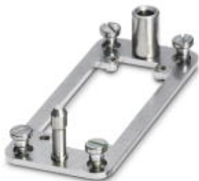
Andockrahmen für Einschübe, für Kontakteinsätze der Bauform B16, mit 4 Flachkopfschrauben M5, Einschubausgleich x/y-Achse +/- 1,5mm
