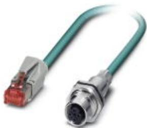
Konfektioniertes Ethernet-Kabel, CAT5e, geschirmt, 2-paarig, AWG 26 flexibel (7-drähtig), RAL 5021 (wasserblau), M12-Einbaubuchse, Hinterwand-/Schraubmontage SPEEDCON auf RJ45-Stecker/IP20, Line, Länge 2 m
