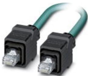
Konfektioniertes Ethernet-Kabel, geschirmt, 4-paarig, AWG 26 schleppkettentauglich (19-drähtig), RAL 5021 (wasserblau), RJ45-Stecker/IP67 Push-Pull Kunststoffgehäuse auf RJ45-Stecker/IP67 Push-Pull Kunststoffgehäuse, Line, Länge 10 m
