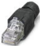
RJ45-Steckverbinder, Schutzart: IP20, Polzahl: 8, 1 GBit/s, CAT5 (IEC 11801:2002), Material: PA, Anschlussart: IDC-Schnellanschluss, Anschlussquerschnitt: AWG 26-23, Kabelabgang: gerade, Farbe: schwarz
