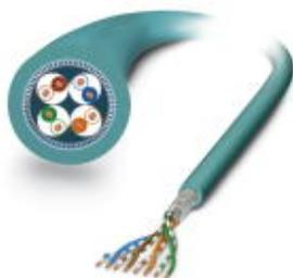
Netzwerkkabel, Ethernet CAT5 (1 GBit/s), 8-polig, PUR halogenfrei, wasserblau RAL 5021, geschirmt, freies Leitungsende, auf freies Leitungsende, Kabellänge: 100 m
