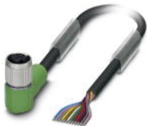
Sensor-/Aktor-Kabel, 12-polig, PUR halogenfrei, schwarz RAL 9005, freies Leitungsende, auf Buchse gewinkelt M12 SPEEDCON, A-kodiert, Kabellänge: 3 m
