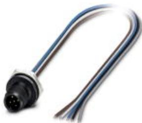
Sensor-/Aktor-Einbausteckverbinder, Stecker, 5-polig, M12, A-kodiert, Vorderwand-/Schraubmontage mit M16 Gewinde, mit 0,5 m TPE-Litze, 5 x 0,25 mm<sup>2</sup>, Kunststoffausführung
