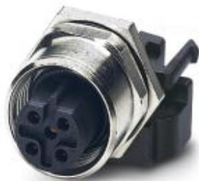
Sensor-/Aktor-Einbausteckverbinder, Buchse, 5-polig, M12, geschirmt, B-kodiert, Hinterwand-/Schraubmontage mit M12 Gewinde, verdrehgeschützt, mit geradem Lötanschluss
