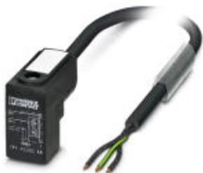
Sensor-/Aktor-Kabel, 3-polig, PVC, schwarz RAL 9005, freies Leitungsende, auf Ventilstecker C (8 mm), mit 1 LED, beschaltet mit Z-Diode, beschaltet mit Z-Diode, Kabellänge: 3 m
