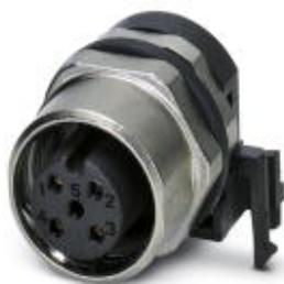
Sensor-/Aktor-Einbausteckverbinder, Buchse, 4-polig, M12-SPEEDCON, A-kodiert, geschirmt, Hinterwand-/Schraubmontage mit M12 Gewinde, verdrehgeschützt, mit gewinkelttem Lötanschluss
