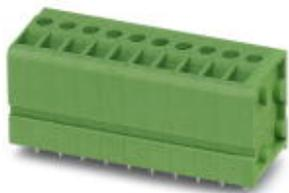
Leiterplattenklemme, Nennstrom: 24 A, Nennspannung: 400 V, Rastermaß: 5 mm, Polzahl: 5, Anschlussart: Frontschraubanschluss, Montage: Wellenlöten, Anschlussrichtung Leiter/Platine: 90 °, Farbe: grün. Der Artikel ist zu unterschiedlichen Polzahlen anreihbar!
