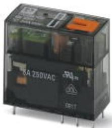
Steckbares Miniaturrelais, mit Leistungskontakt, 2 Wechsler, Prüftaste, mechanische Schaltstellungsanzeige, Status-LED, Spulenspannung 230 V AC
