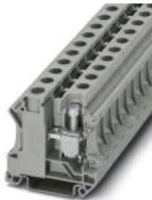
Installationsklemme, Schraubanschluss, Querschnitt: 6 mm<sup>2</sup> - 25 mm<sup>2</sup>, AWG: 10 - 4, Breite: 12,2 mm, Farbe: grau, Montageart: NS 35/7,5, NS 35/15
