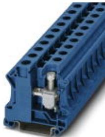
Installationsklemme, Schraubanschluss, Querschnitt: 6 mm<sup>2</sup> - 25 mm<sup>2</sup>, AWG: 10 - 4, Breite: 12,2 mm, Farbe: blau, Montageart: NS 35/7,5, NS 35/15
