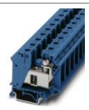
Installationsklemme, Schraubanschluss, Querschnitt: 0,75 mm² - 35 mm², AWG: 18 - 2, Breite: 15,2 mm, Farbe: blau, Montageart: NS 35/7,5, NS 35/15
