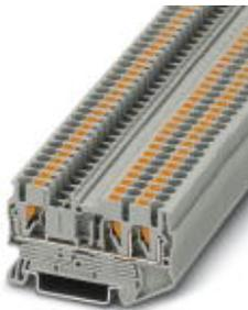
Durchgangsklemme, Nennspannung: 800 V, Nennstrom: 24 A, Anschlussart: Push-in-Anschluss, Anzahl der Anschlüsse: 3, Querschnitt: 0,14 mm<sup>2</sup> - 4 mm<sup>2</sup>, AWG: 26 - 12, Breite: 5,2 mm, Höhe: 35,2 mm, Farbe: grau, Montageart: NS 35/7,5, NS 35/15
