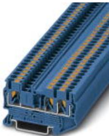
Durchgangsklemme, Nennspannung: 800 V, Nennstrom: 24 A, Anschlussart: Push-in-Anschluss, Anzahl der Anschlüsse: 3, Querschnitt: 0,14 mm<sup>2</sup> - 4 mm<sup>2</sup>, AWG: 26 - 12, Breite: 5,2 mm, Höhe: 35,2 mm, Farbe: blau, Montageart: NS 35/7,5, NS 35/15
