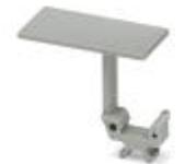
Gruppenbezeichnungsschild, einrastbar in Klemmenmitte für Schraub-, Zugfeder- und Schnellanschlussklemmen, beschriftbar mit einem Etikett 25 x 12 mm, oder manuell mit dem B-STIFT, im Fußteil mit ZB 5
