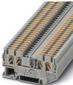
Durchgangsklemme, Nennspannung: 800 V, Nennstrom: 24 A, Anschlussart: Push-in-Anschluss, Anzahl der Anschlüsse: 4, Querschnitt: 0,14 mm<sup>2</sup> - 4 mm<sup>2</sup>, AWG: 26 - 12, Breite: 5,2 mm, Höhe: 35,3 mm, Farbe: grau, Montageart: NS 35/7,5, NS 35/15
