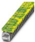
Anschlussklemme, Anschlussart: Schraubanschluss, Belastungsstrom: 41 A, Querschnitt: 0,5 mm<sup>2</sup> - 6 mm<sup>2</sup>, Breite: 7 mm, Farbe: grün-gelb
